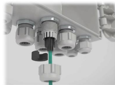
大径のケーブルグラウンドで、アッセンブリ済み ケーブルを挿入可能。はめ込み型シールによる確実な防水
