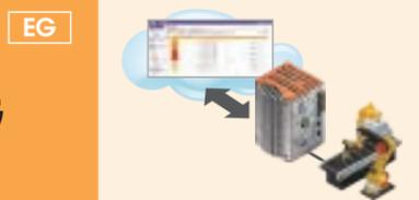
DINレールマウント型ファンレスWindows PC。CONPROSYSのI/Oモジュールを活用でき、セキュリティソフトを搭載したIoT Edgeコントローラです。
